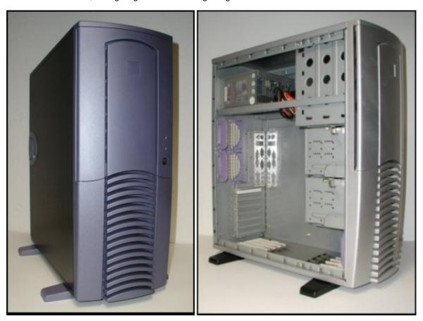
Wie man auf dem rechten Bild sehen kann sind an der Rückseite Aufnahmen für zusätzliche Gehäuselüfter vorgesehen, die den Luftstrom weiter beschleunigen und damit einen noch besseren Luftaustausch erzeugen.
